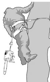
La possibilità di fissare direttamente la motosega all'imbracatura a cinghia riduce il rischio di danni all'attrezzatura durante i movimenti attorno all'albero. Togliere sempre l'alimentazione della motosega quando è direttamente fissata all'imbracatura a cinghia. È opportuno collegare la motosega ai punti di attacco raccomandati sull'imbracatura a cinghia.
