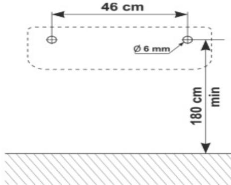
**IMPORTANTE:** per un corretto montaggio, che non interferisca con il funzionamento del termostato e permetta il massimo sfruttamento del calore prodotto, è necessario montare il termoconvettore ad almeno 180 cm dal pavimento. Si consiglia inoltre di lasciare almeno 50 cm di spazio al di sopra e sui lati del prodotto. Assicurarsi che non ci siano impedimenti alla libera uscita dell'aria o sulle prese d'aria.
