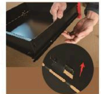
Step 6: assemblare la guida P per tutti e 6 i cassetti. Tenere le guide rivolte verso l'altro.
