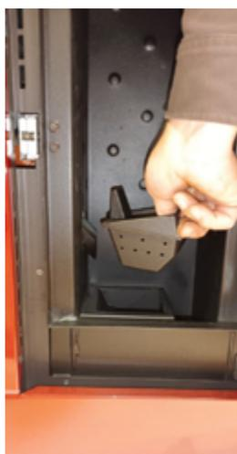
**Fig. 32 - Rimozione braciere**
