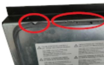
Fig. 25 - Guarnizione deteriorata
