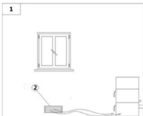
Fig. 7 - Afflusso d'aria diretta
