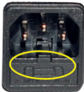
Fig. 99 - Sportellino con i fusibili da rimuovere
