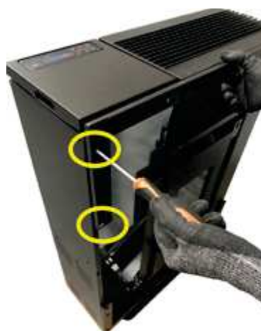
Fig. 35 - Fissaggio staffa superiore
