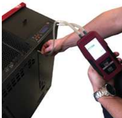
Fig. 86 - Collegamento pressostato digitale
