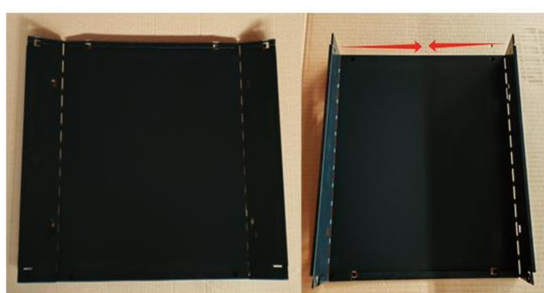
Step 1: Piega verso l'interno il cassetto Q
