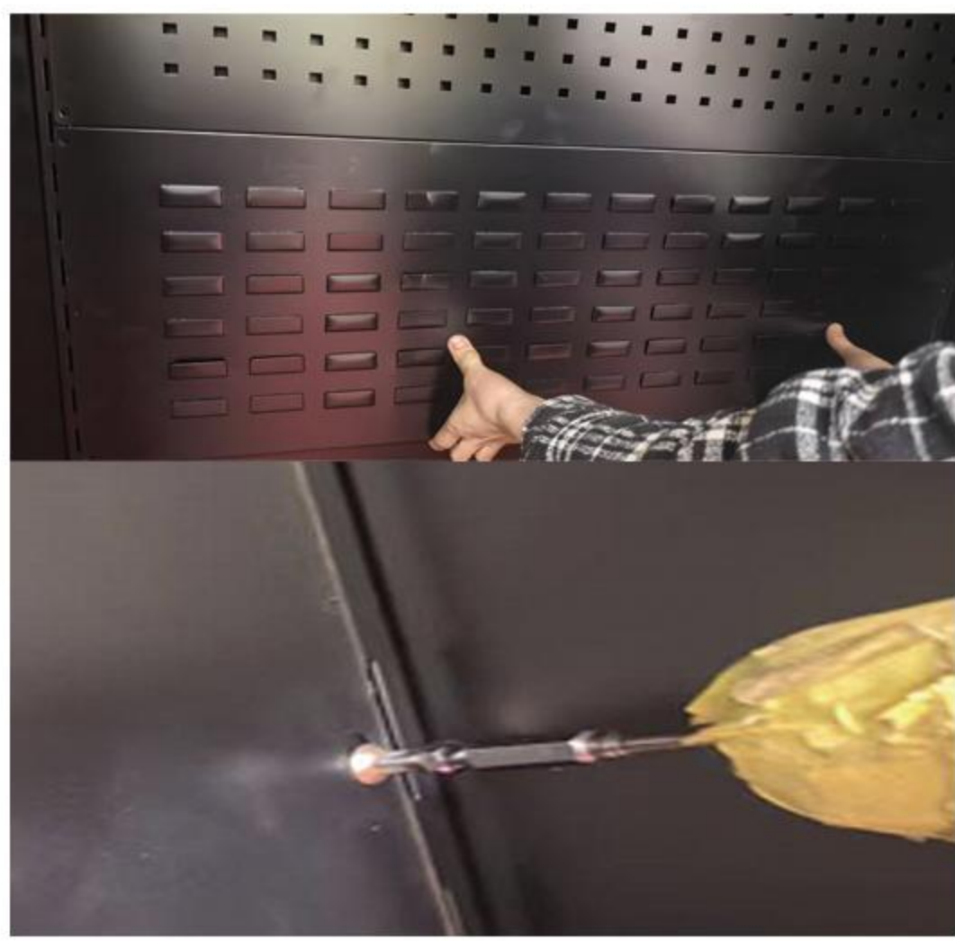
Step 8: Assembla il pannello non forato O utilizzando 6 viti (L-M5).
