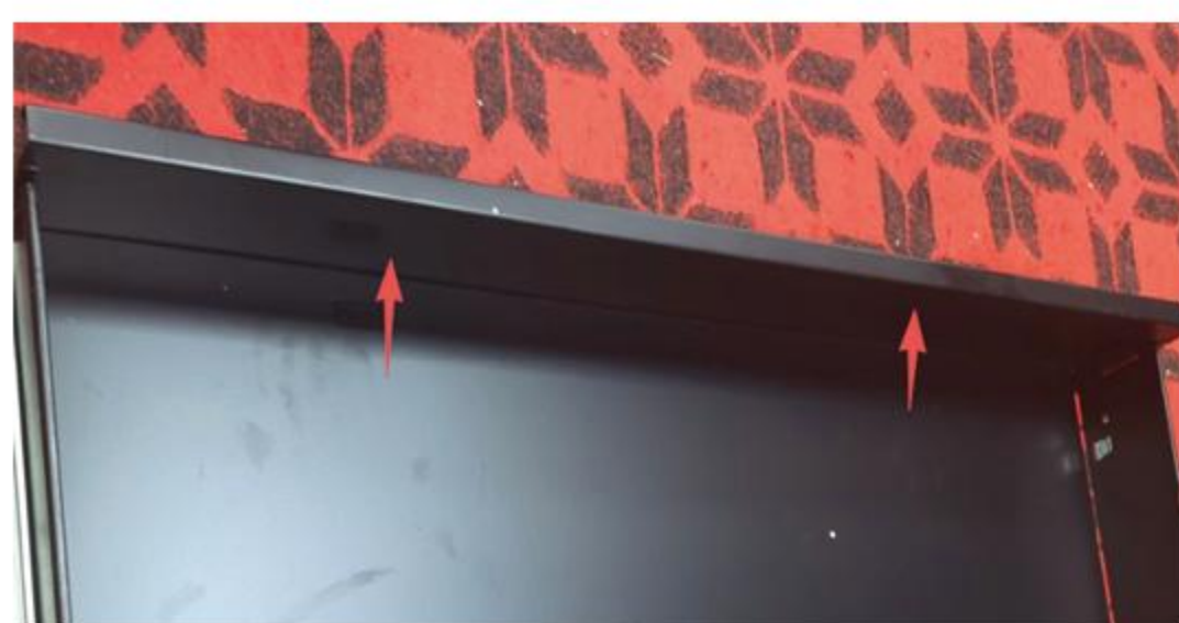
Step 4: Assembla la piastra interna frontale del cassetto N.
