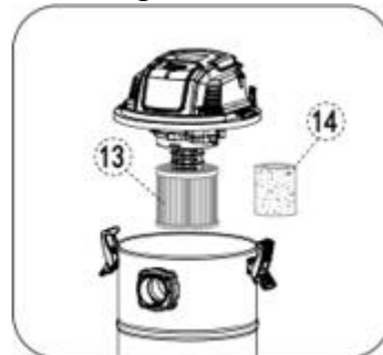
Inserire il filtro Hepa o il filtro in spugna per i liquidi
