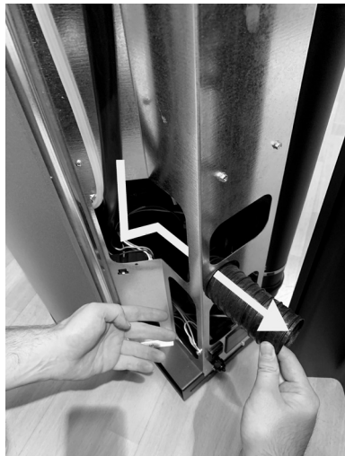
Fig. 56 - Passaggio tubo flessibile 1
