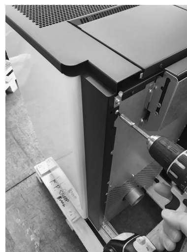
Fig. 39 - Fissare il fianco completo
